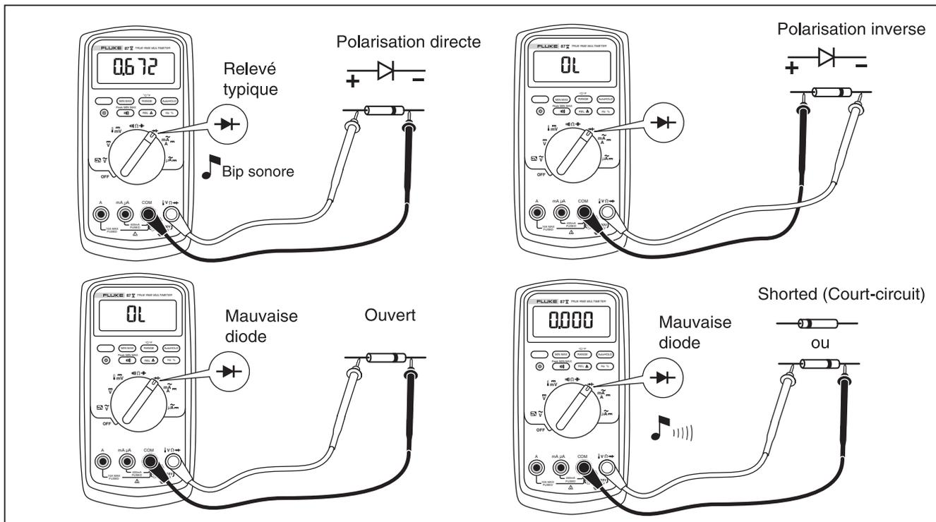
Figure 7. Contrôle d'une diode
