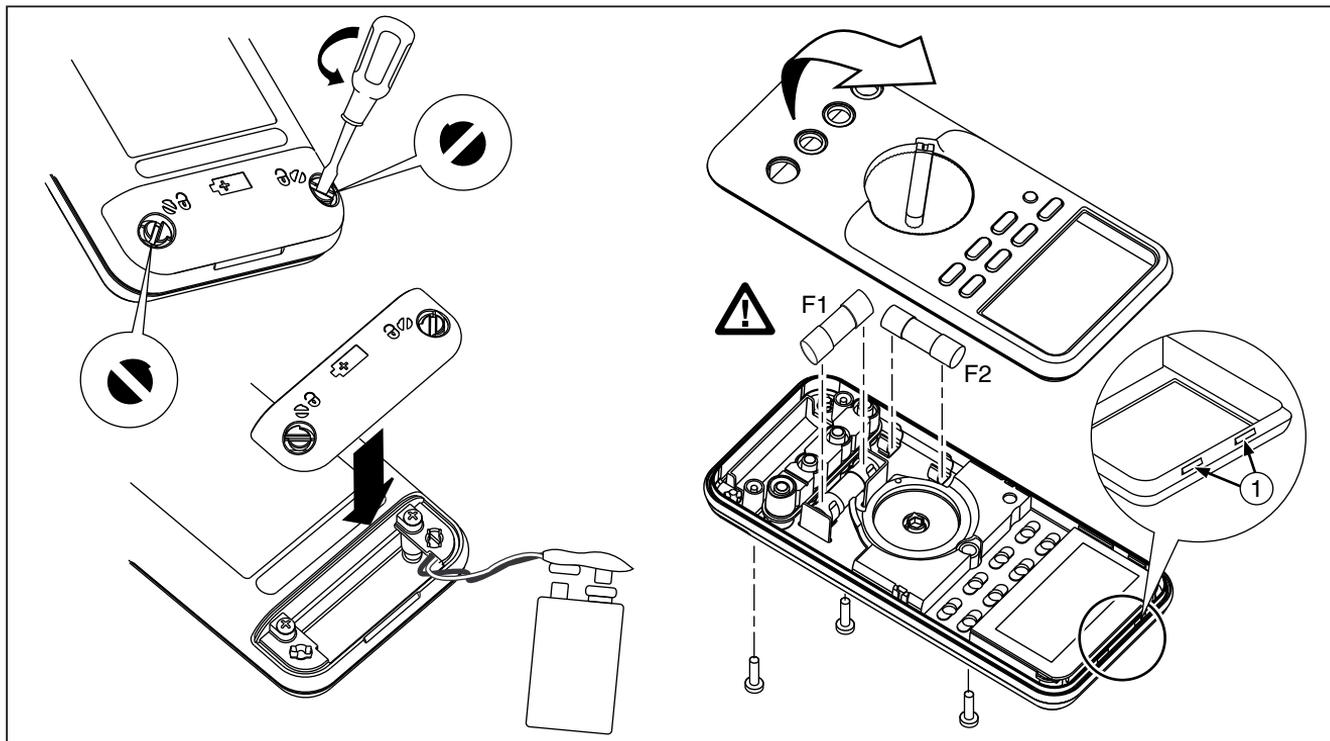
**Figure 11. Remplacement d'une pile ou d'un fusible**
