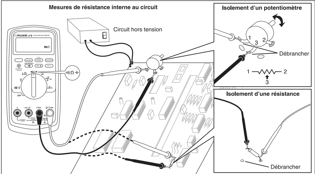
Figure 5. Mesure de résistance
