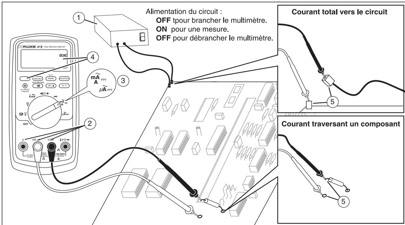
Figure 8. Mesure de courant
